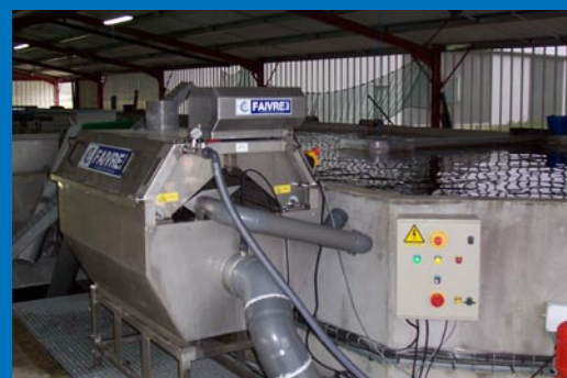
Modell 4-80 med 36µ rist på resirkuleringssystem.
