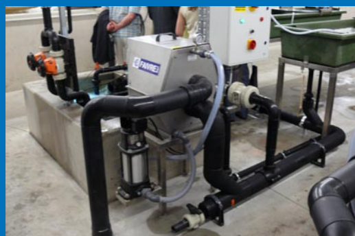
Modell 2-40 med 36µ rist på resirkuleringssystem.
